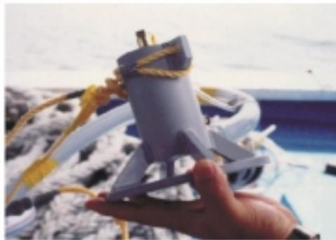
図-3 カキ用マイクロバブル発生装置
