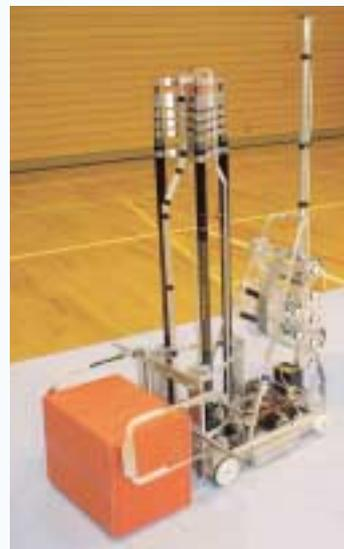
から競技フィールドに降りることに成功しました。完成したマシンは、最初にスタートゾーンと階段状に積まれた箱の間にエアシリンダーを伸ばし、それでマシンを支えながら箱を押し上げたスペースに降りて、前につけたアーム
