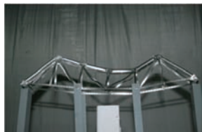
ステンレスブリッジの破壊状況
