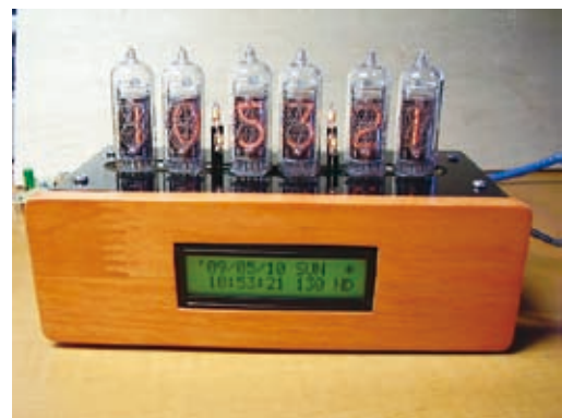
電波時計 with nixie tube (2009.5.10完成)
