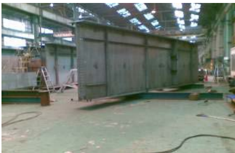
(資材の説明 プレートガーダーの組み立て デジタル検査 非破壊検査)
